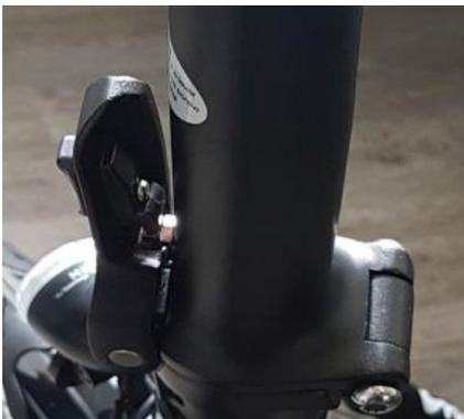
5. Der Lenker kann nun in das Rohr eingesteckt und mit dem Schnellspanner befestigt werden.
